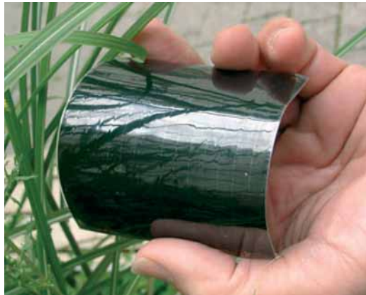
Abbildung 5 Flexibles Dünnschicht- modul auf Kupfer- Indium-Diselenid (CIS)-Basis
