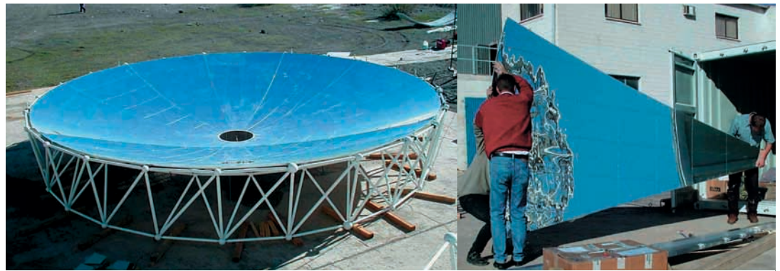
Abbildung 4 Konzentratorschale und Segmenthandling
