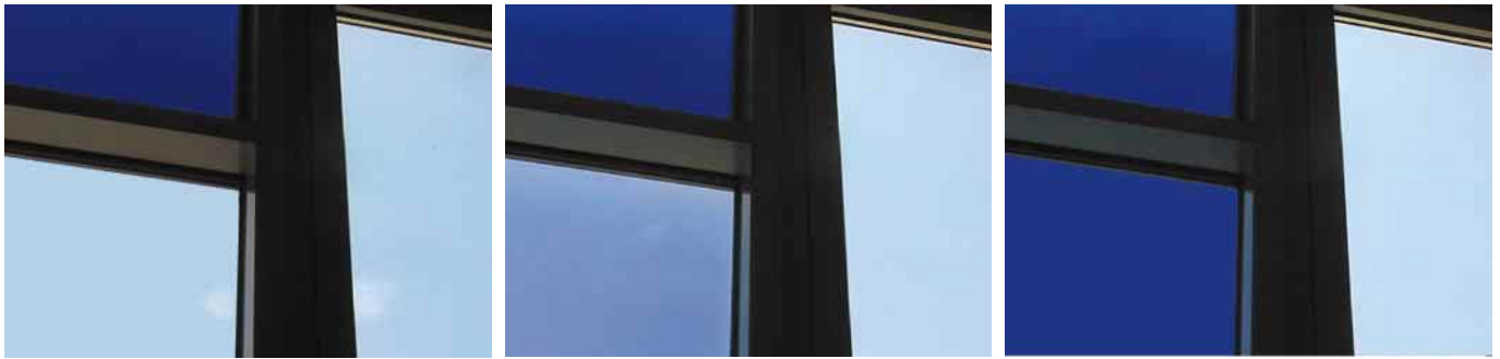
Abbildung 15 Schaltbare Verglasung auf der Basis einer katalytischen Gasreaktion im Scheibenzwischenraum einer Doppelverglasung. Scheibe oben links: geschalteter Zustand mit geringster Transmission; Scheibe rechts: ungeschalteter Zustand; Scheibe unten links: Schaltprozess in einer Folge.
