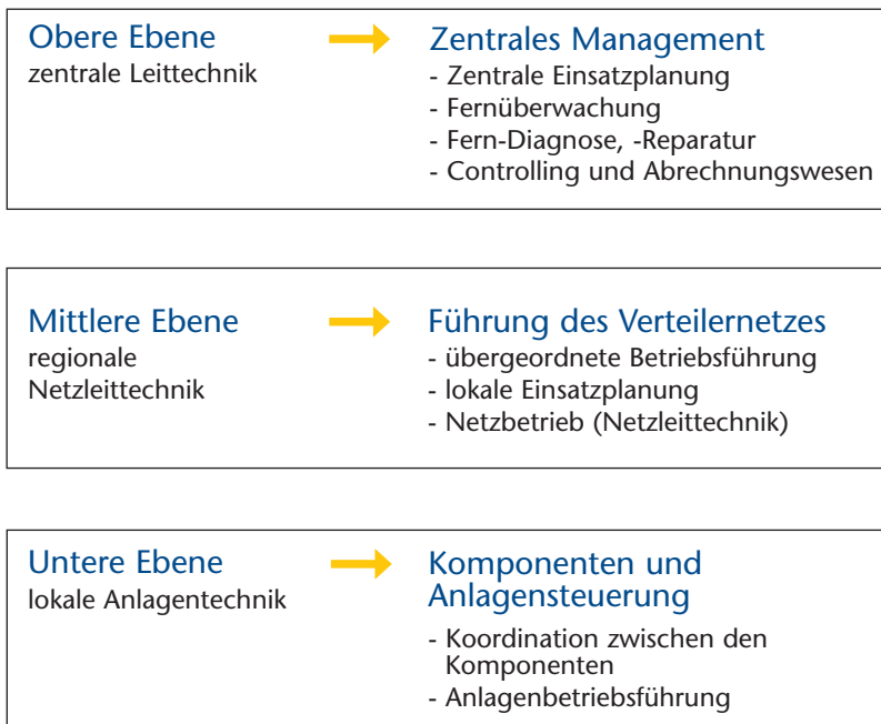
Abbildung. 5: Kommunikation in der Energieversorgung – Strukturen und Aufgaben
