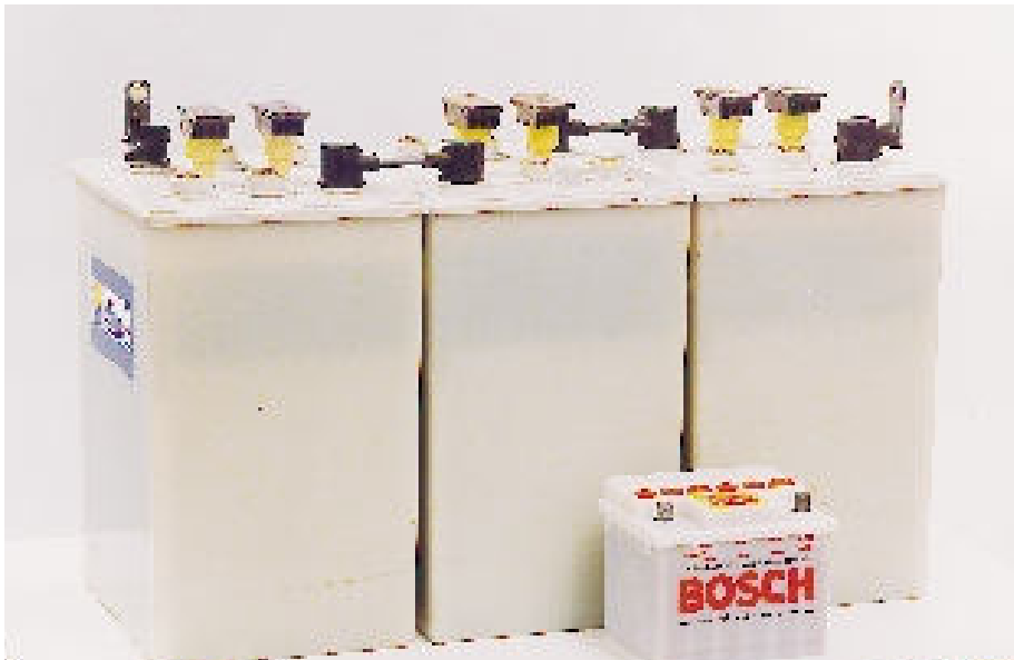
Abbildung 2: Unterschiedlichste Größen von Bleibatterien kommen in photovoltaischen Anlagen zum Einsatz. Neben kleinen Solarbatterien (12 V, 100 Ah) existieren größere Batterieverbände, die aus z.T. großen Einzelzellen (z.B. 2 V, 1500 Ah) aufgebaut sind.
