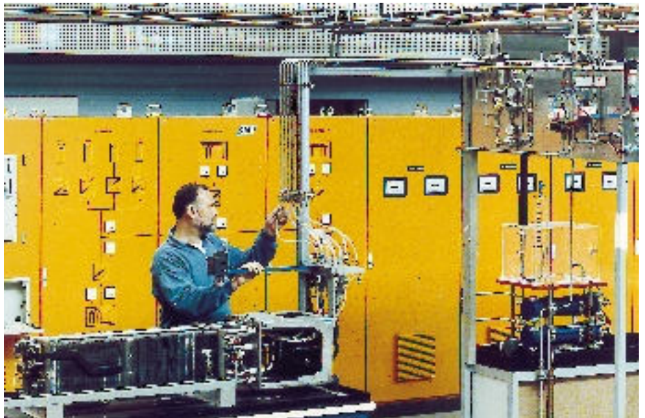
Abbildung 12: Die 6,5 kW alkalische Brennstoffzelle vom Typ Siemens BZA 4-2 der PHOEBUS-Anlage
