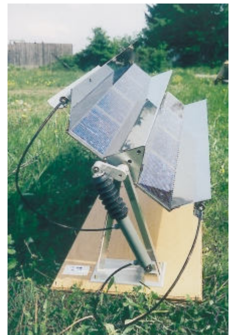
Abbildung 5: PV V-Trog Funktionsmodell mit einer Fläche von 0,5 m 2
