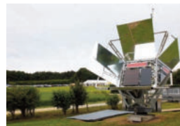
Solartracker für beschleunigte Alterungstests mit dreifacher Konzentration (Standort: Solar-Testfeld Widderstall)
