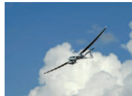
Startfähig mit der Brennstoffzelle: Motorsegler Antares DLR-H2
