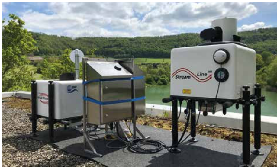
Abbildung 3 Windmessungen mit Lidar: Verbund aus synchronisierten Lidar-Scannern und einem Lidar-Profilier Quelle: ZSW
