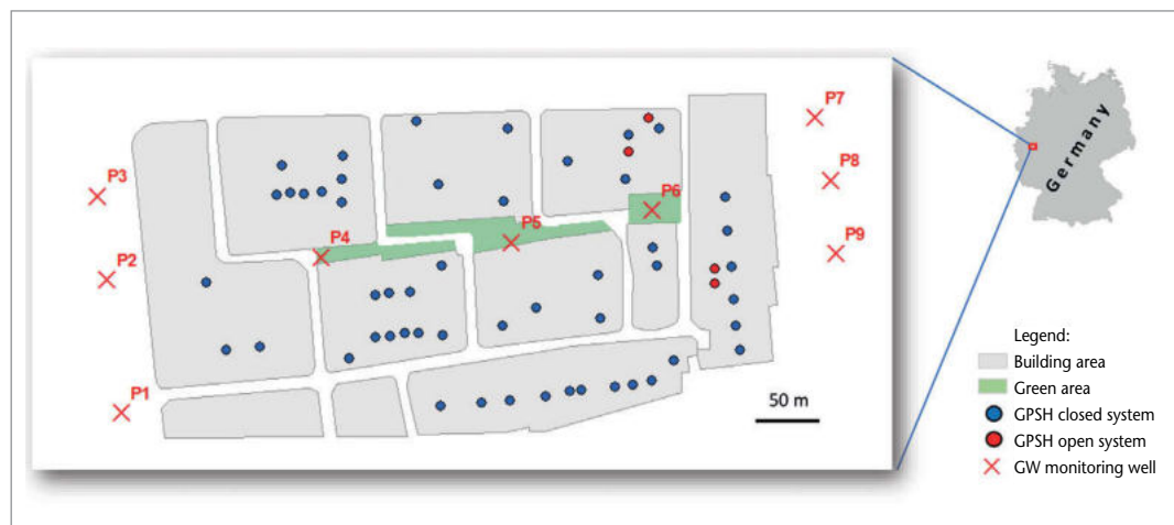
Abbildung 4 Lageplan des betrachteten Erdwärmepumpensystems [UFZ]
