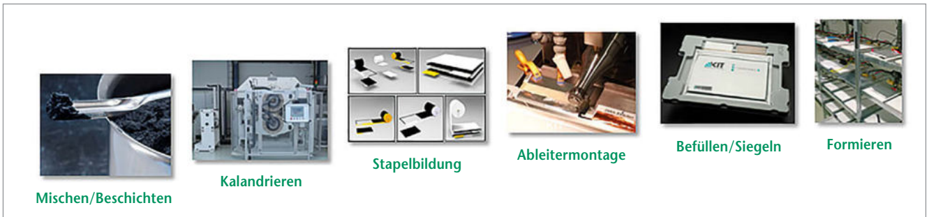
Abbildung 3 Prozesskette zur Batterieherstellung © KIT
