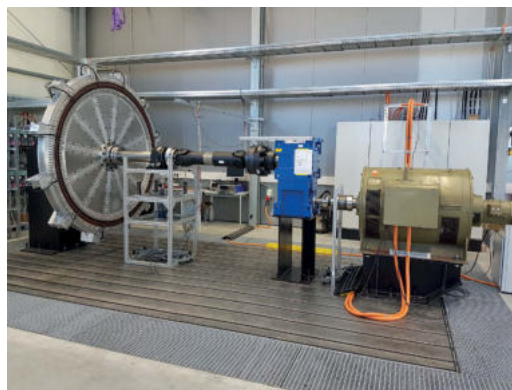
Abbildung 3 Magnetrings-Generator im Labormaßstab (176 kW) [Quelle: Fraunhofer IWES, Kassel]
