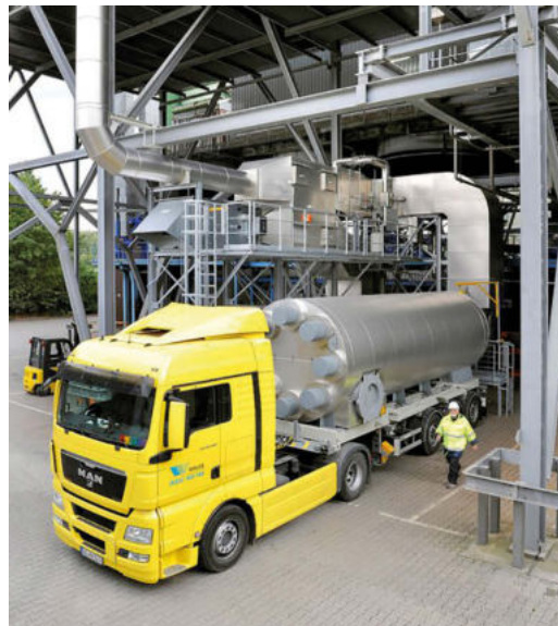
Abbildung 7 mobiler Sorptions- speicher zur Nutzung industrieller Abwärme (ZAE Bayern)
