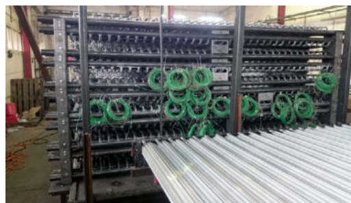
Abbildung 8 Wärmeübertrager für Hochleistungs-Latent- wärmespeicher (DLR)
