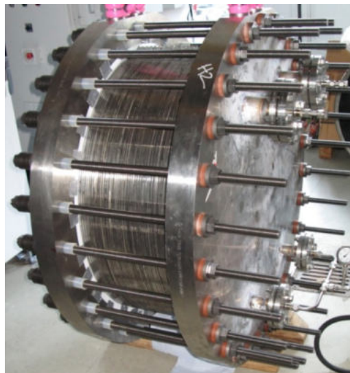
Abbildung 3 24-zelliger Elektrolyseblock (Quelle: ZSW)
