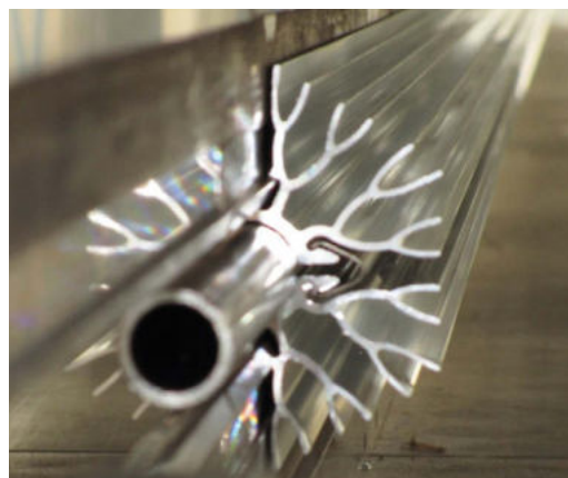
Abbildung 3 Beripptes Rohr für den Testspeicher
