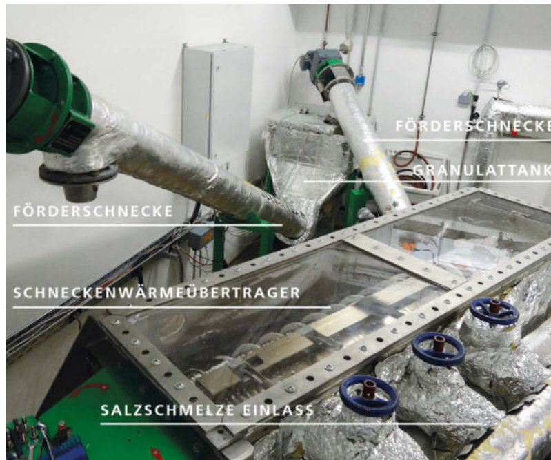
Abbildung 7 Schneckenwärmeübertrager zur Latentwärmespeicherung (Fraunhofer ISE)
