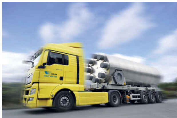
Abbildung 4 Mobiler Sorptions- speicher mit Zeolith zur Nutzung industrieller Abwärme einer Müllverbrennungs- anlage (ZAE Bayern)
