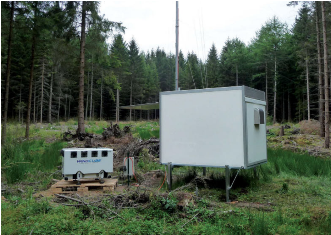
Abbildung 6 LiDAR-Gerät zur Windmessung mit Lasertechnologie (IWES)
