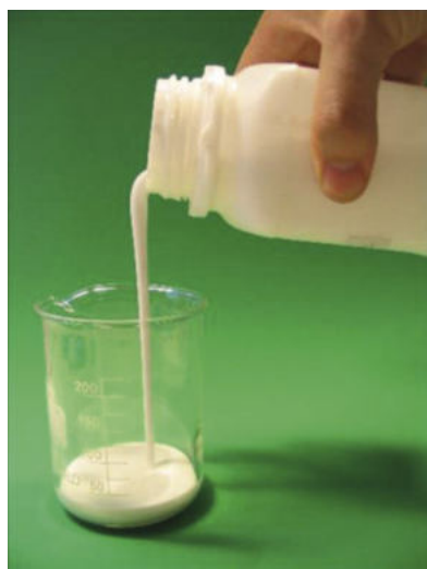
Abbildung 4 In Wärmeträgerfluiden verteilte Latentwärmespeicher
