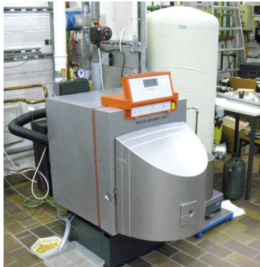
Abbildung 6 Teststand für die Untersuchung von Heizkesseln unter stark wechselnden Betriebsbedingungen Quelle: Ostfalia
