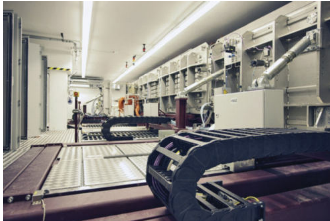
Abbildung 4 Anlage für Rolle-zu-Rolle-Verfahren für die CIS-Technologie (ZSW)
