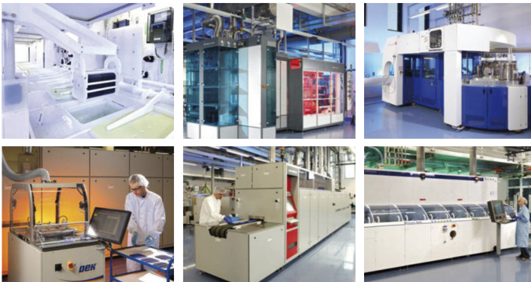
Abbildung 2 SolarTeC am ISFH: Industrietytische Prozessanlagen für die Herstellung von Solarzellen aus kristallinen Silicium-Wafern
