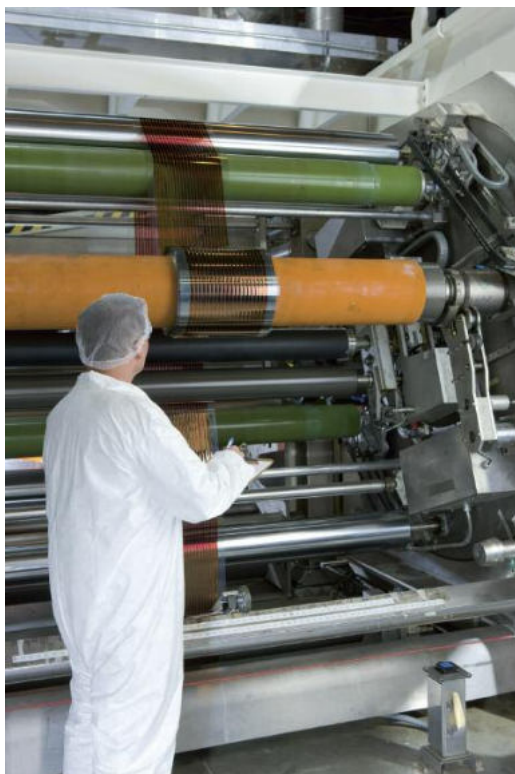
Abbildung 3 Industrielle Rolle-zu-Rolle-Fertigung von organischen Solarmodulen. (Bildquelle: Konarka)
