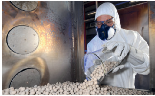
Keramik-Materialien im Test als Wärmespeicher © DLR
