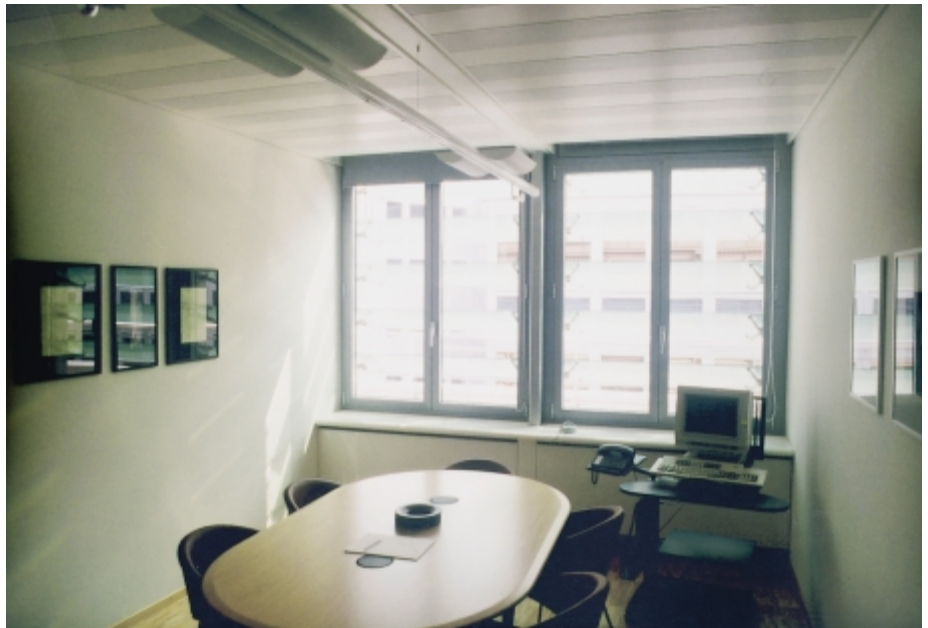
Abbildung 1: Raumeindruck bei einer Glaslamellen-Beschattungsanlage, die dem Sonnenstand nachgeführt wird. Der Gesamtenergiedurchlass ist auf ca. 30 % reduziert, während die Tageslichttransmission etwa 30-40 % beträgt. Es besteht ein guter Blickkontakt nach außen.
