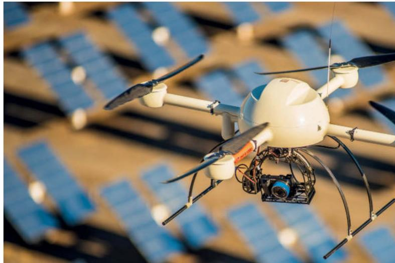
Dabei wird das Spiegelbild des Absorberrohrs in den Spiegelfacetten des Kollektors genutzt, um die Formabweichung und Richtungsabweichung des Spiegels vom Idealzustand zu ermitteln. Mittels numerischer Modelle lässt sich daraus die optische Effizienz des Kollektorfeldes orts aufgelöst bestimmen. Dies gibt dem Betreiber des Kraftwerks wichtige Hinweise in Bezug auf die Steuerung seiner Anlage und die Notwendigkeit zur Nachjustierung seiner Kollektoren.
