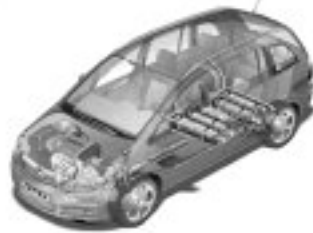
Zafira 1.6 CNG mit 200 bar Erdgas-Tank
