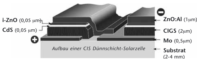
Abbildung 1 Schematischer Aufbau einer CIGS-Dünnschichtsolarzelle mit monolithischer Verschaltung von zwei Einzelzellen
