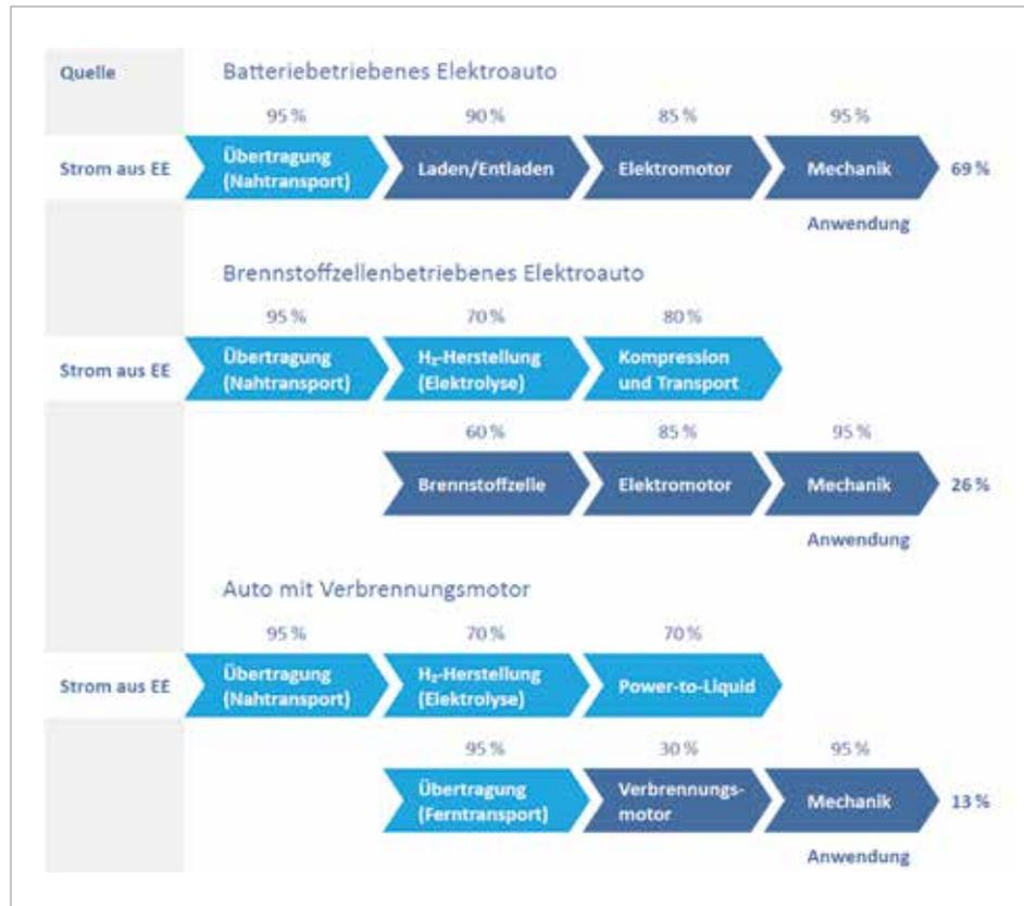
Der Nachteil dieser indirekten Elektrifizierung gegenüber einer direkten Elektrifizierung besteht jedoch in den erheblichen Wirkungsgradverlusten, die exemplarisch für den Pkw-Bereich in ► **Abbildung 2** dargestellt sind. So erreicht ein batteriebetriebenes Elektrofahrzeug einen Gesamtwirkungsgrad von 69%, während ein brennstoffzellenbetriebenes Elektrofahrzeug nur auf einen Gesamtwirkungsgrad von 26% kommt. Noch schlechter sieht dies bei einem Auto mit Ver-
