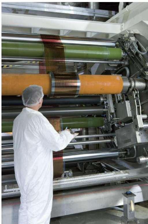
Abbildung 3 Industrielle Rolle-zu-Rolle-Fertigung von organischen Solarmodulen. (Bildquelle: Konarka)
