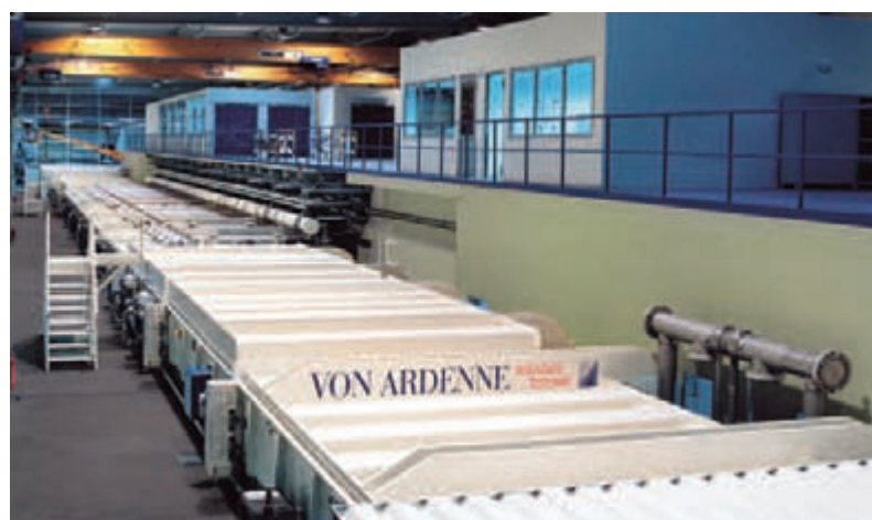
Abbildung 3 Architekturglasbeschichtungsanlage zur Abscheidung von Wärmeschutzschichten auf Glas mit der Größe von 19,2m 2
