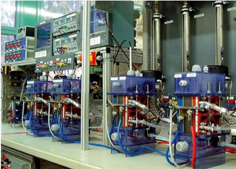
Abbildung 11 Versuchsaufbau für Alterungsmessungen an fünfzelligen Stacks im Labor
