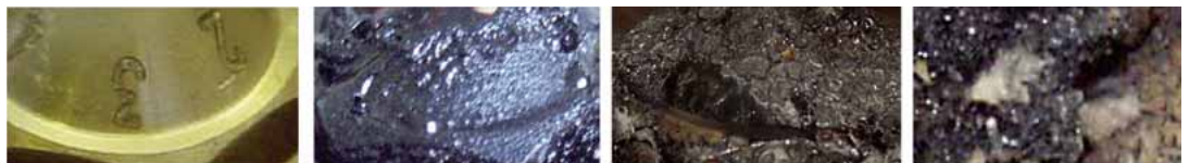
Abbildung 5 Kohlenstoffhaltige Ablagerungen bei der Diesel-Reformierung bei falscher Tempera- tureinstellung
