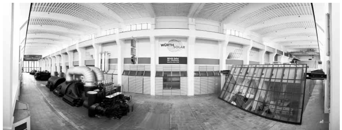
Abbildung 9 180°-Ansicht der Maschinenhalle des stillgelegten Dampfkraftwerkes der EnBW in Marbach am Neckar mit der darin integrierten CIS- Pilotfertigung von Würth Solar.
