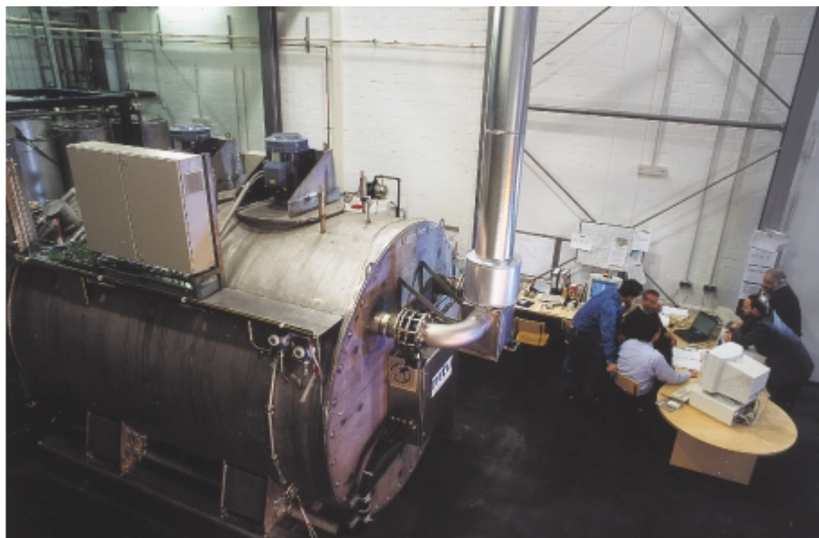
Abbildung 6: 280kW el Hot Module Anlage der MTU Friedrichshafen, die zur Zeit an der Universität Bielefeld getestet wird.
