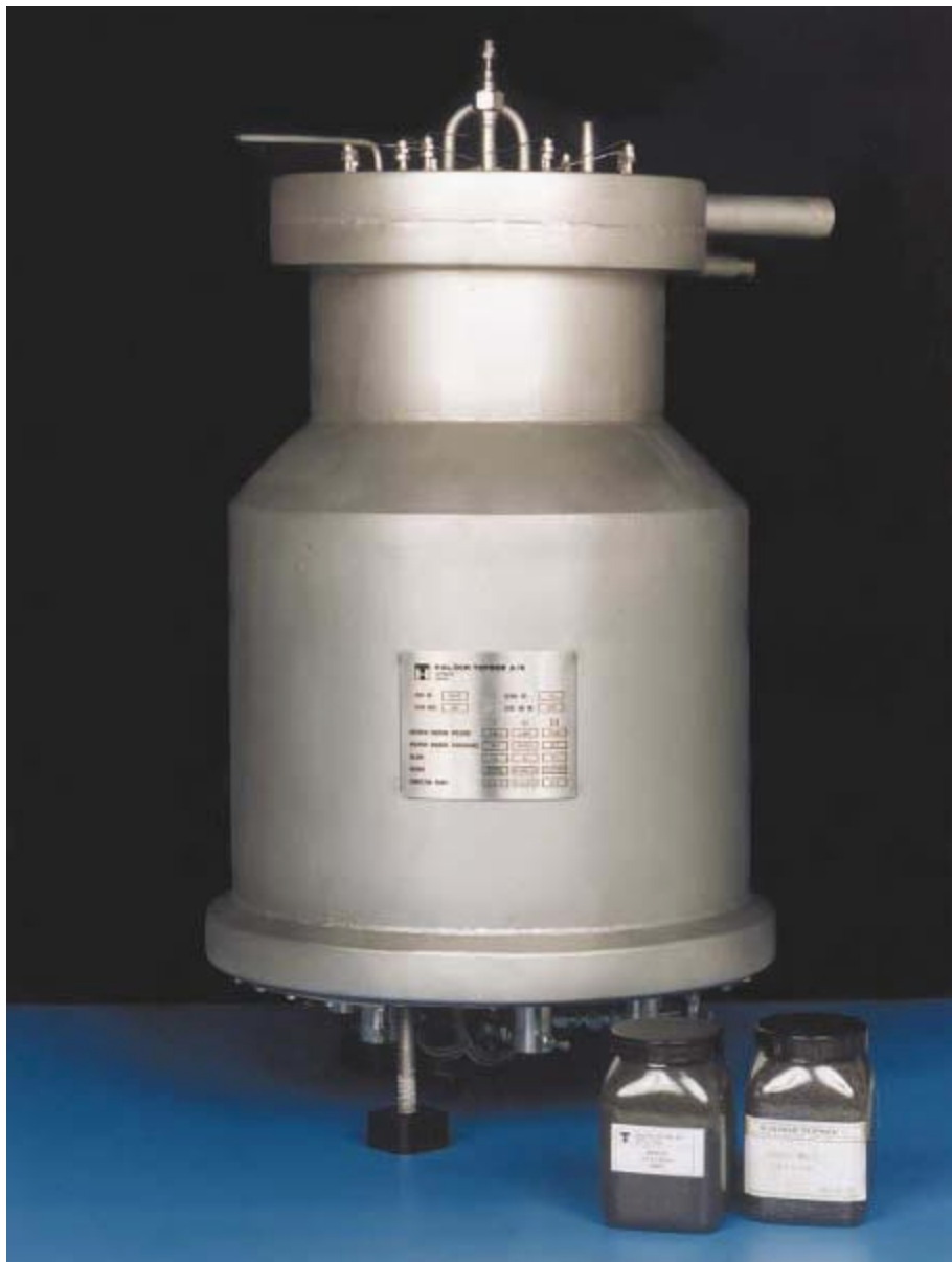
Abbildung 7: Kompakt-Methanol-Reformer, gebaut in einer Zusammenarbeit zwischen Haldor Topsøe und dem IWW 3, Forschungszentrum Jülich
