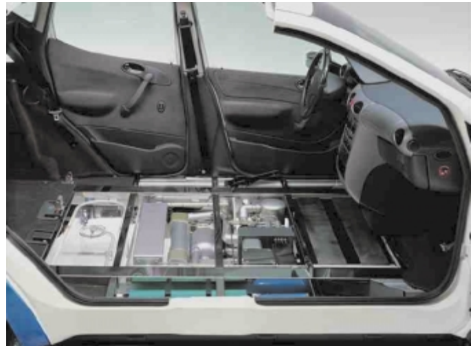
b) Im NECAR 4 finden sämtliche Brennstoffzellenkomponenten im Unterboden Platz.
