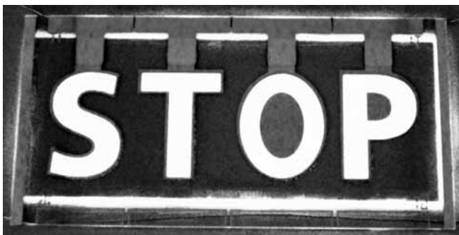
Abbildung 3 OLED-Symbol 50 \times 100\ \text{mm}^2 , rot mit pii-Struktur, hergestellt in der VES400/13 am IPMS.
