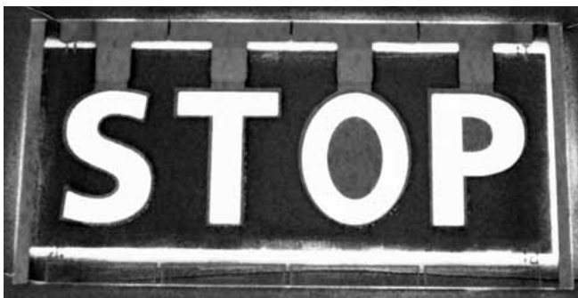
Abbildung 3 OLED-Symbol 50 x 100 mm 2 , rot mit pii-Struktur, hergestellt in der VES400/13 am IPMS.
