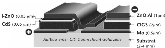
Abbildung 1 Schematischer Aufbau einer CIGS-Dünnschichtsolarelle mit monolithischer Verschaltung von zwei Einzelzellen
