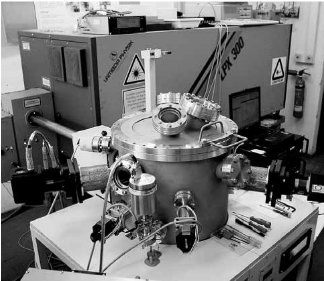
Abbildung 1 PLD-UHV-Kammer mit in-situ spektroskopischem Ellipsometer (vorn) und Excimerlaser (hinten) im PLD-Labor der Abteilung Halbleiterphysik in der Universität Leipzig (Foto M. Lorenz)
