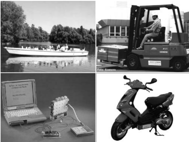
Abbildung 5 Demonstrationsanwendungen Hybrid-BZ-Systeme; links oben: MS Hydra (Etaing, Zetek, GfE u.a.); rechts oben: BZ-Gabelstapler (Linde, Siemens, GfE u.a.); links unten: BZ-Notebook (FhG ISE, Siemens Nixdorf, GfE u.a.); rechts unten: Peugeot-Roller mit H 2 -Verbrennungsmotor (Zeitler Motor Speinshart, GfE)
