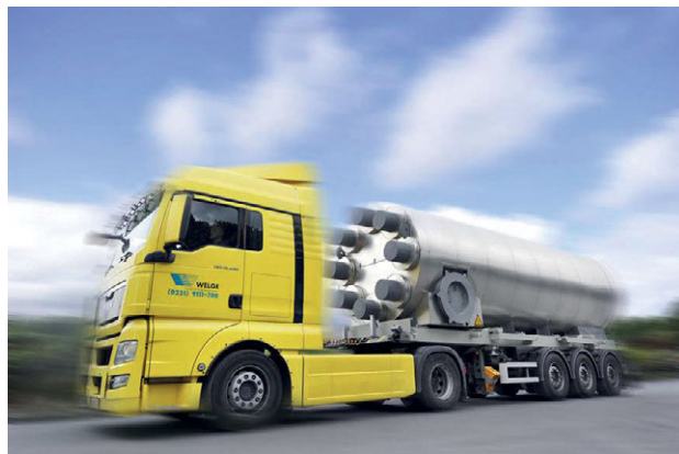
Abbildung 4 Mobiler Sorptionspeicher mit Zeolith zur Nutzung industrieller Abwärme einer Müllverbrennungsanlage (ZAE Bayern)
