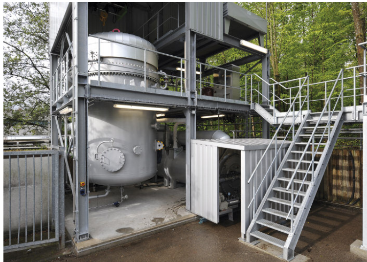
Abbildung 2 HOTREG Feststoff-Speicher-Testanlage des DLR
