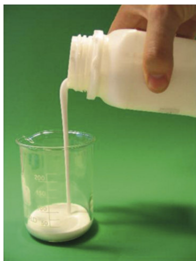
Abbildung 4 In Wärmeträgerfluiden verteilte Latentwärmespeicher
