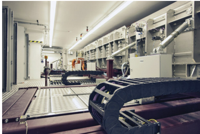
Abbildung 4 Anlage für Rolle-zu-Rolle-Verfahren für die CIS-Technologie (ZSW)
