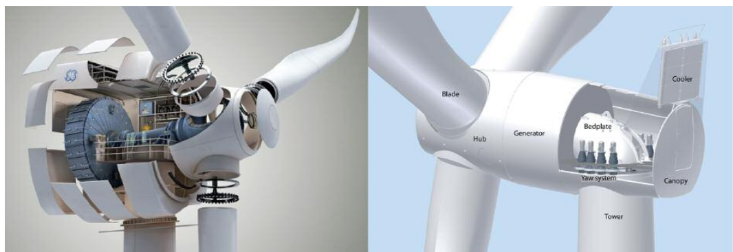
Abbildung 1 Windenergieanlagen mit Permanentmagnet-Synchrongeneratoren der neusten Generation. Links: Anlage der Firma GE Energy (Leistung 4 MW, Generatordurchmesser 6,6 m, spezifische Turmkopfmasse ca. 60 t/MW, Photo courtesy of GE Energy). Rechts: Anlage der Firma Siemens (Leistung 3 MW, Generatordurchmesser 4,2 m, spezifische Turmkopfmasse ca. 45 t/MW, Siemens Pressebild).
