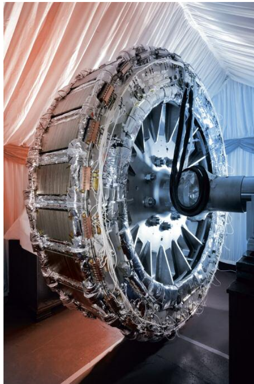
Abbildung 2 Prototyp eines supraleitenden Synchrongenerators für getriebelose Windenergie- anlagen. Image Courtesy of Converteam UK.
