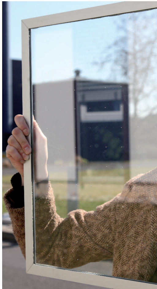
Abbildung 3 Blick durch ein Vakuumisoliertglas (Prototyp VIG) mit U_g = 0,5 \text{ W}/(\text{m}^2\text{K})
