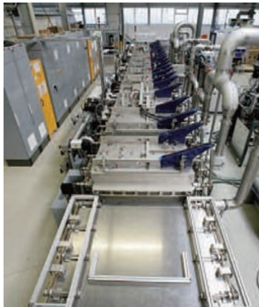
Abbildung 2 Die neue Generation Plasmaprozesssysteme für neue, kombinier - bare Prozesse (Plasma- ätzen + Beschichten)
