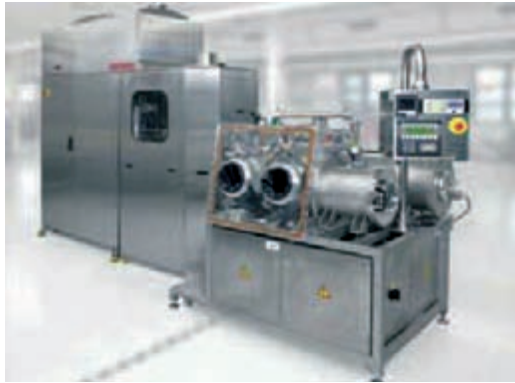
Abbildung 3 OVPE-Beschichtungs- anlage am HMI
