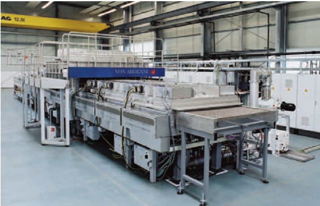
Abbildung 2 Pilotanlage zur Abscheidung von metallischen Schichten bei hohen Tempera- turen auf Glas mit der Größe von 0,72m 2
