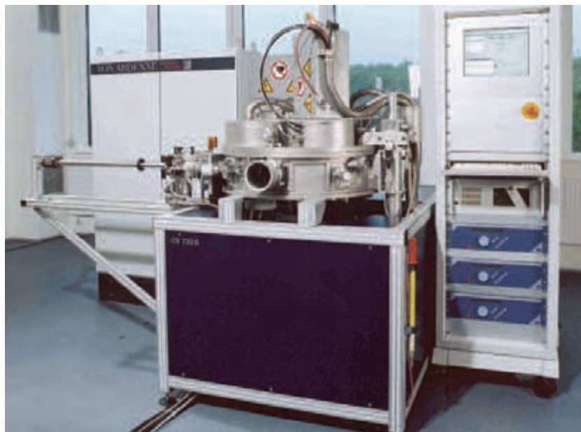
Abbildung 1 Clustersystem zur Abscheidung von metallischen und transparenten leit- fähigen Schichten mittels Magnetron- sputtern
