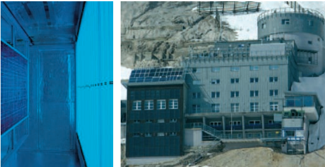
Abbildung 1 UV-Tests von Solar- modulen (links) müssen verschärft und mit Feuchte-Wärme kombiniert werden, um der Belastung bei 20 Jahren Gebrauchs- dauer zu entsprechen. Vergleichstests mit Frei- bewitterung (rechts) dienen der Validierung von beschleunigten Gebrauchsdauer- prüfungen.
