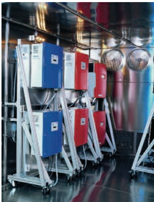
Abbildung 2 Begehbare und automatisierte Klimakammer für entwicklungs- und serienbegleitende Feldtests von Photovoltaikwechselrichtern
